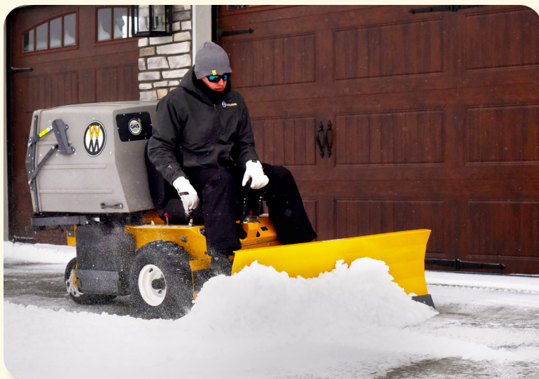
Bordes de desgaste de acero reemplazables
